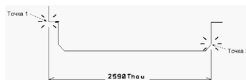
Рис. 13. Простановка линейного ортогонального размера.
