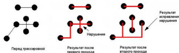
Рис. 2. Принцип работы многопроходного алгоритма.
