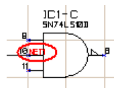
Рис. 14. Автоматически добавленная метка цепи.
