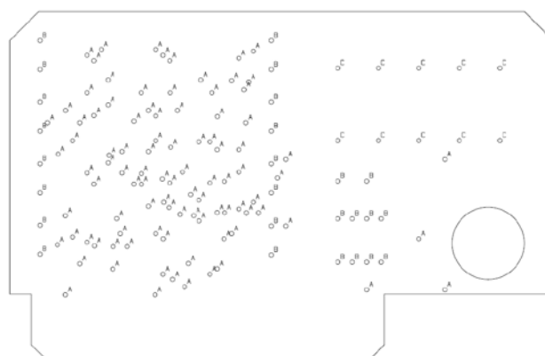
Рис. 38. Полученная нами карта сверловки.
