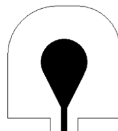
Рис. 30. Скругление вырезов в областях заливки.
