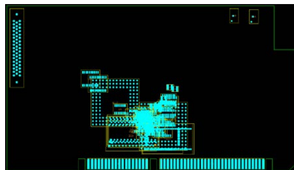
Рис. 9. Результат работы процедуры размещения Place on Minimum Force.
