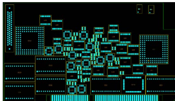
Рис. 10. Результат работы процедуры размещения Refine Placement.
