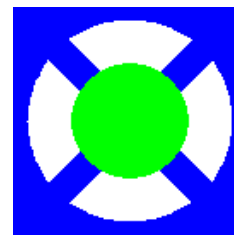
Рис. 32. Соединение переходного отверстия с полигоном.
