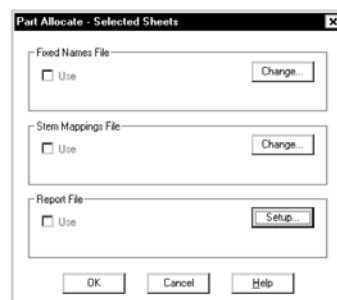
Рис. 5. Настройки автоматического присвоения позиционных обозначений.
