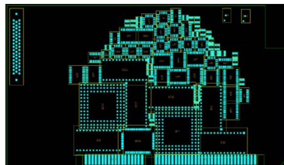
Рис. 15. Результат работы процедуры размещения Autoplace с новыми настройками.
