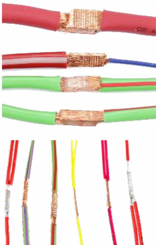
**Установка Tech-Sonic US-3020WN предназначена для сращивания проводов суммарным поперечным сечением от 0,5 до 28 мм<sup>2</sup>. Конструкция оборудования включает в себя компактные настольные модули, цветной графический дисплей, встроенную библиотеку сварочных параметров. Модель US-3020WN - это проверенное временем решение, более 15 лет присутствия на мировом рынке автомобильной промышленности.**
