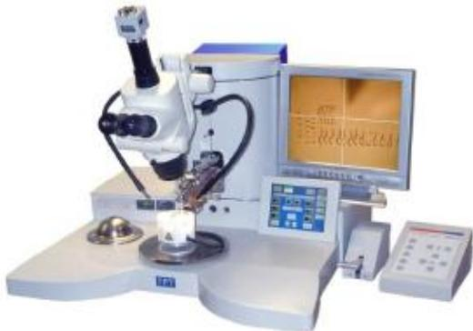
Сварочная головка с глубоким доступом
