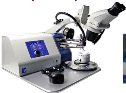
Сварочная головка с глубоким доступом
