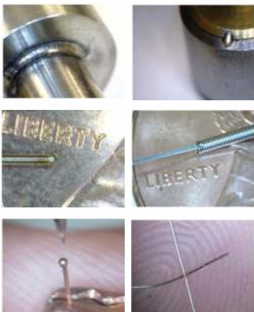
**Установка ORION 200i<sup>2</sup> для импульсно-дуговой и резистивной сварки позволяет легко, быстро и эффективно сваривать различные изделия. Режим с низкой энергией сварочного импульса (10 мДж) предназначен для сварки компонентов миниатюрных размеров. Установка также может работать в режиме прихватки, отличающемся высокой частотой сварочных импульсов.**
