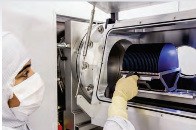
Чистая комната для отладки различных применений технологии АСО оборудована для проведения пробных напылений на образцы заказчика и проведения различных НИОКР.
