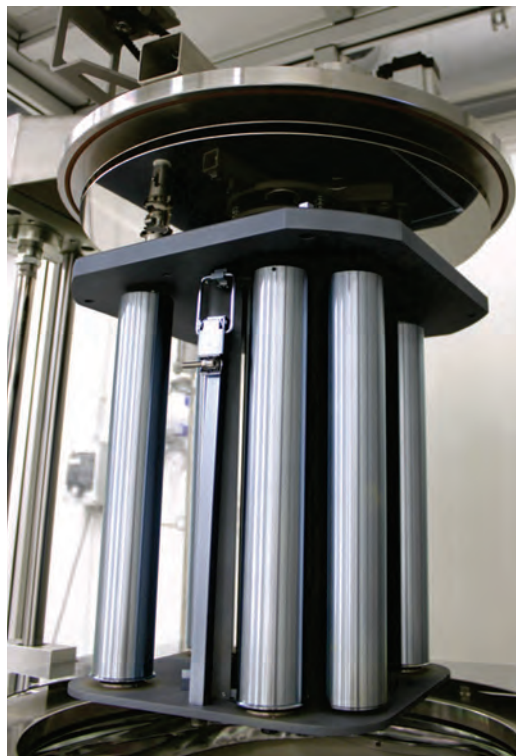
Опция рулонной обработки Picosun позволяет проводить непрерывное АСО на изделия, имеющие большие площади.
