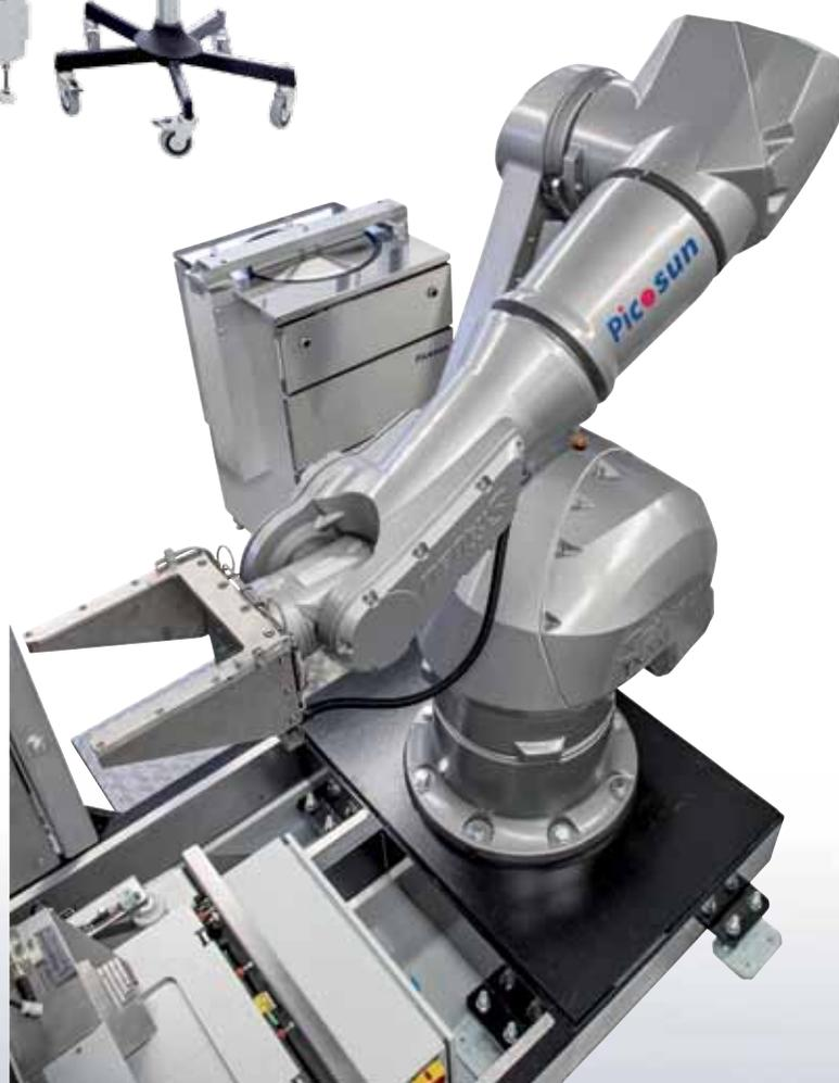
Промышленный инструмент АСО плёнок PICOSUN™ P-300В с промышленным роботом.
