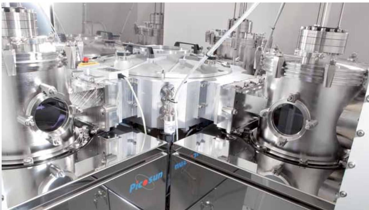
Кластерная система ACO PICOPLATFORM™ 200 с четырьмя инструментами ACO PICOSUN™ R-серии.
