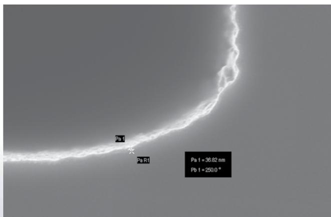
Плёнки ПАСО TiN + Si, обладающие высокой конформностью и однородностью, на поверхностях микроканалов.
