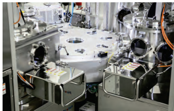
Вакуумный кластер PICOPLATFORM™ 200, состоящий из трех систем ACO PICOSUN™ P-300F Pro с механизмом вращения кассеты с пластинами в вакууме и центральным роботизированным манипулятором Brooks MX700™ (нижняя фотография).
