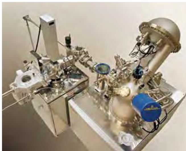
Рис.4. Оборудование Picosun R-серии, интегрированное с рентгеновским спектрометром Thermo Fisher Scientific для проведения in vacuo измерений синтезируемых пленок
