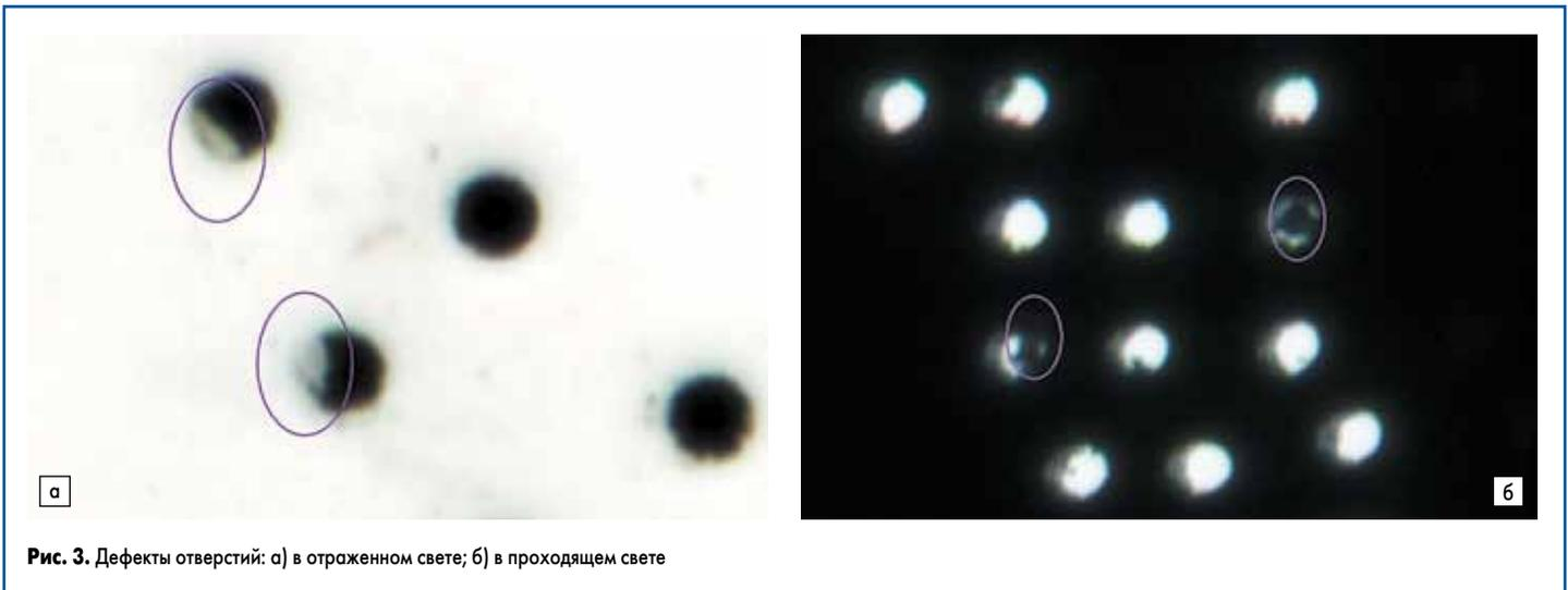
Рис. 3. Дефекты отверстий: а) в отраженном свете; б) в проходящем свете
