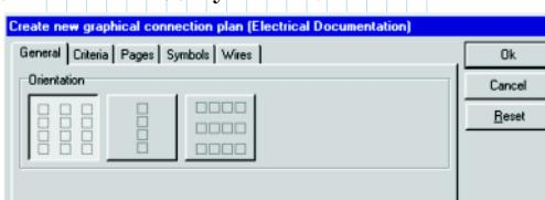
Часть предварительных настроек нового модуля подобна настройкам, существующим в модулях автоматической генерации планов клеммных и кабельных соединений проекта. Пользователь может выбрать один
