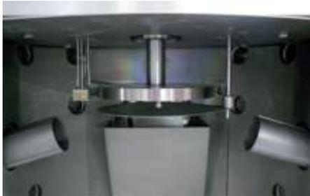
**Установки Kenosistec KE 500/1000 предназначены для напыления пленок различных материалов методом термического испарения или элетронно-лучевым способом; позволяют работать с подложками различной формы и размеров. Модели KE 500/1000 идеально подходят для лабораторных исследований и производства мелкой партии изделий; управляются автоматически или в ручном режиме с помощью ПК/ПЛК.**
