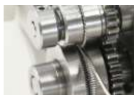
Устройство подачи припоя с защитой от формирования шариков припоя
