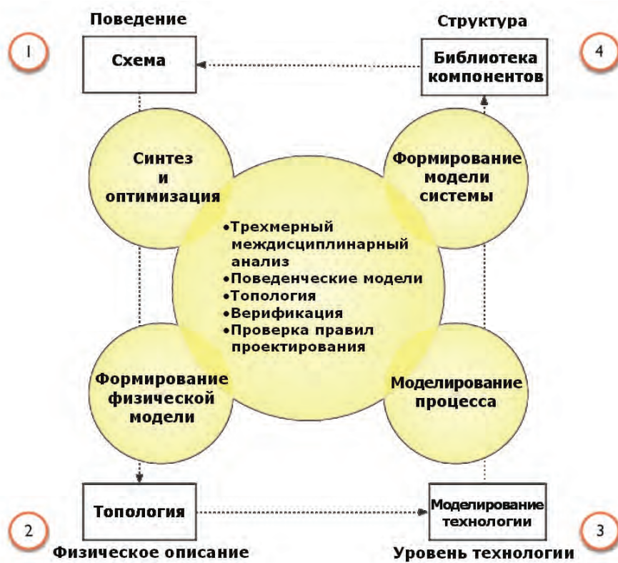
Рис. 5.4. Интеграция основных этапов проектирования МЭМС
