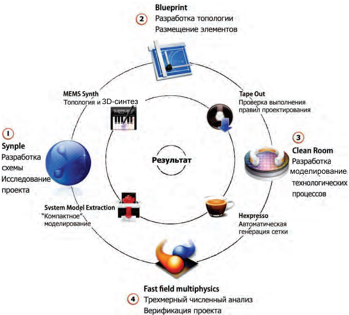
Рис. 5.5. Процесс проектирования МЭМС в пакете IntelliSuite
