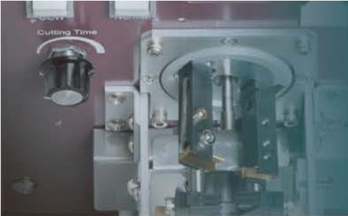
Установка для зачистки электрических проводов (стриппер)
