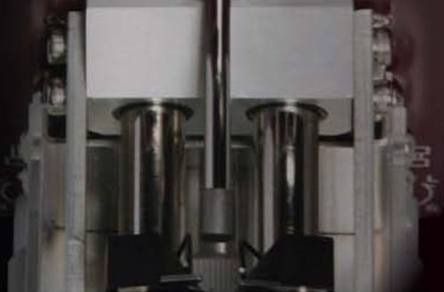
Установка для зачистки электрических проводов (стриппер)
