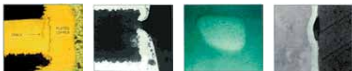
Рис. 1. Дефекты, возникающие во влажной среде: трещины, пустоты, конденсат, эффект «попкорна»
