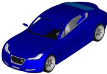
Корпус автомобиля. Электрически большой объект с множеством мелких деталей и большими элементами поверхности с относительно простой геометрией. Хорошо моделируется методом матриц линий передач (TLM).
