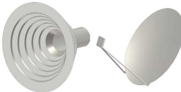
Рупорный облучатель. Широкополосная задача, хорошо моделируется во временной области (вычислитель T).
