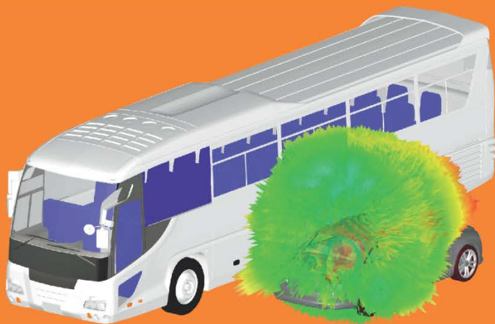
Пример расчета диаграммы направленности V2V антенны, установленной на легковом автомобиле, затененном стоящим рядом автобусом.
