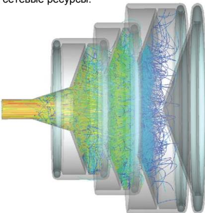
СВЧ коллектор с рекуперацией: электроны замедляются электростатическими полями и поглощаются металлическими стенками, моделируется вторичная электронная эмиссия. В результате анализа получаются траектории элементарных частиц (слева), а также распределение тепла в конструкции (справа).
