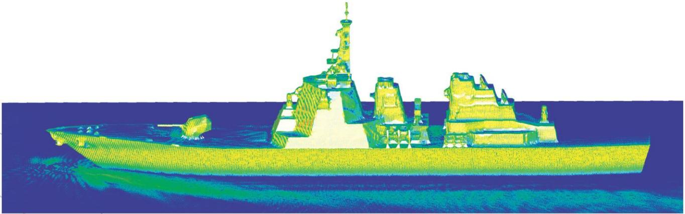
Распределение токов на металлической поверхности корабля длиной 155 метров и облучаемого плоской волной сигнала с частотой 400 МГц. При моделировании учитывалась относительная диэлектрическая проницаемость соленой воды (81) и ее удельная проводимость (0.01 См/м)
