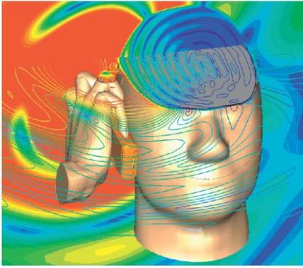
Моделирование распространения сигнала, излучаемого сотовым телефоном, в голове человека. Анализ коэффициента поглощения (SAR) и распространения электромагнитного поля сотового телефона Sony Ericsson на частоте 1.8 ГГц. Трехмерная модель телефона была получена из CAD системы через формат STEP и комбинирована с воксельной моделью руки и головы человека.
