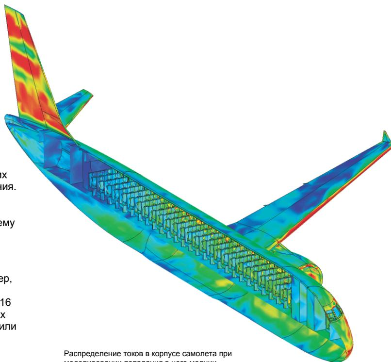
Распределение токов в корпусе самолета при моделировании попадания в него молнии.
