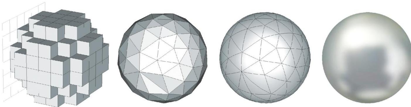
Для моделирования этой сферы могут использоваться различные методы построения сетки разбиения: классические для прямоугольных и тетраэдральных ячеек, а также оригинальная технология CST аппроксимации для идеальных граничных условий (Perfect Boundary Approximation, PBA).
