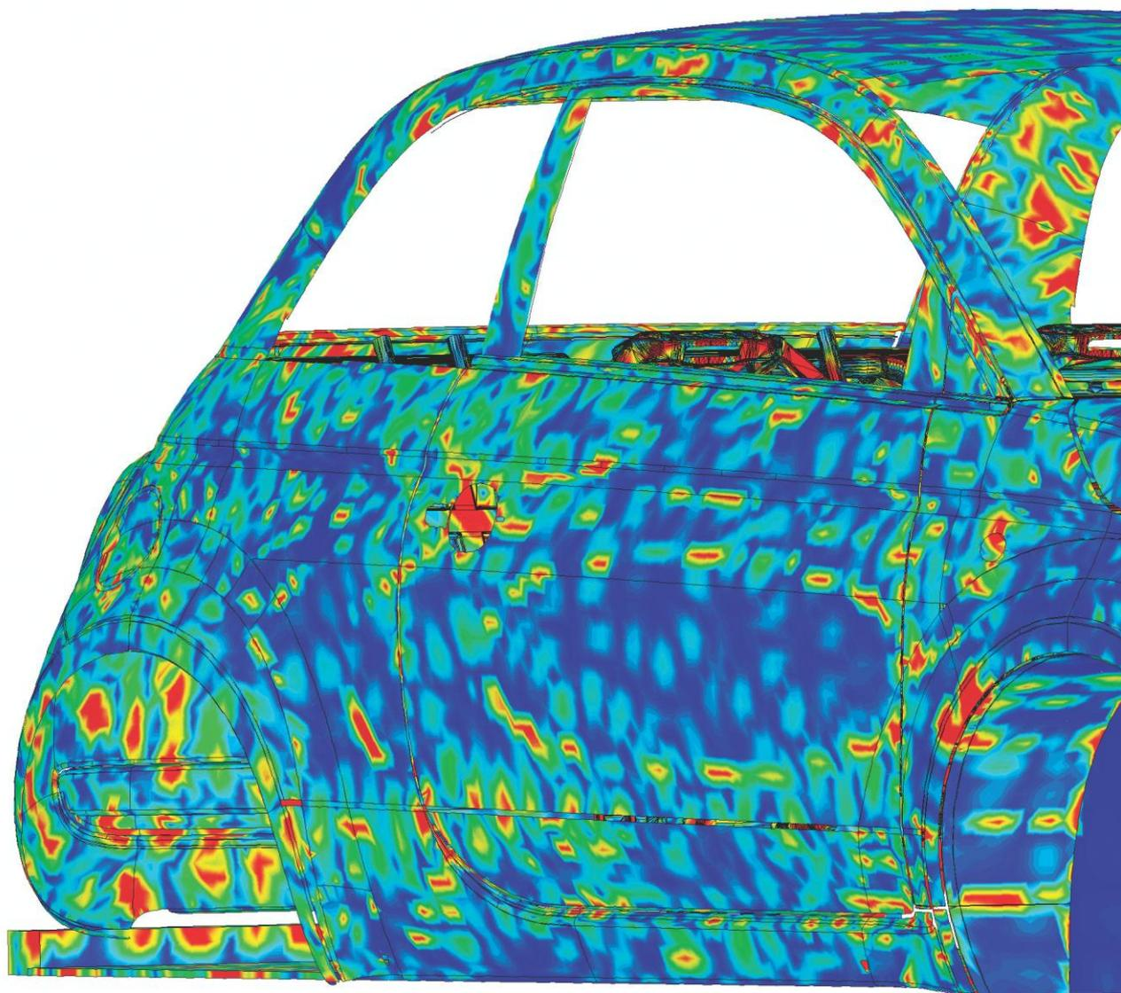
Распределение токов на металлической поверхности автомобиля, наведенных расположенной внутри кабины антенной.
