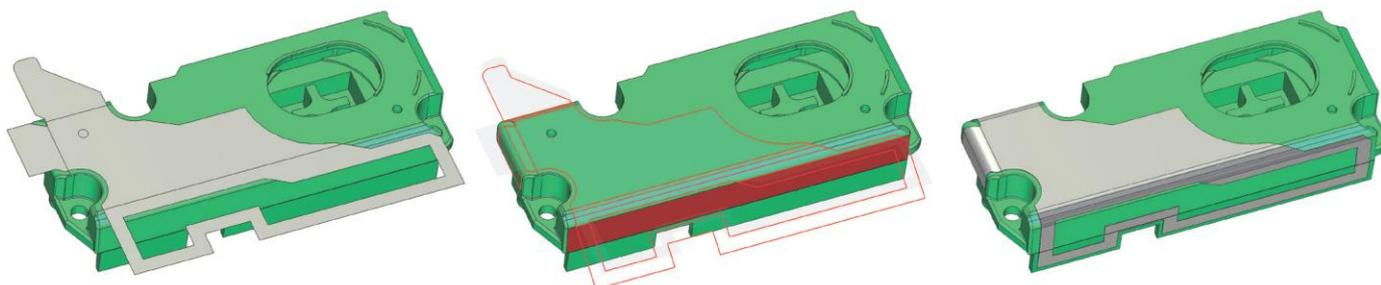
Различные функции, например, изгиб детали, позволяют существенно ускорить и упростить процесс построения трехмерной модели.
