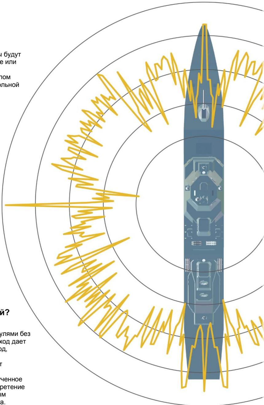
Результат моделирования RCS корабля на частоте 16.8 ГГц
