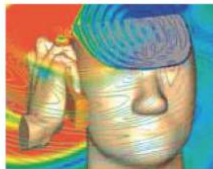
Моделирование распространения сигнала, излучаемого сотовым телефоном, в голове человека. Анализ коэффициента поглощения (SAR) и распространения электромагнитного поля сотового телефона Sony Ericsson на частоте 1.8 ГГц. Трехмерная модель телефона была получена из CAD системы через формат STEP и комбинирована с воксельной моделью руки и головы человека.
