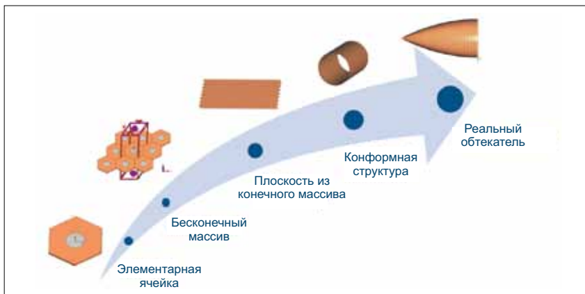
▲ Рис. 3. Шаги по проектированию и анализу периодической структуры для создания обтекателя
