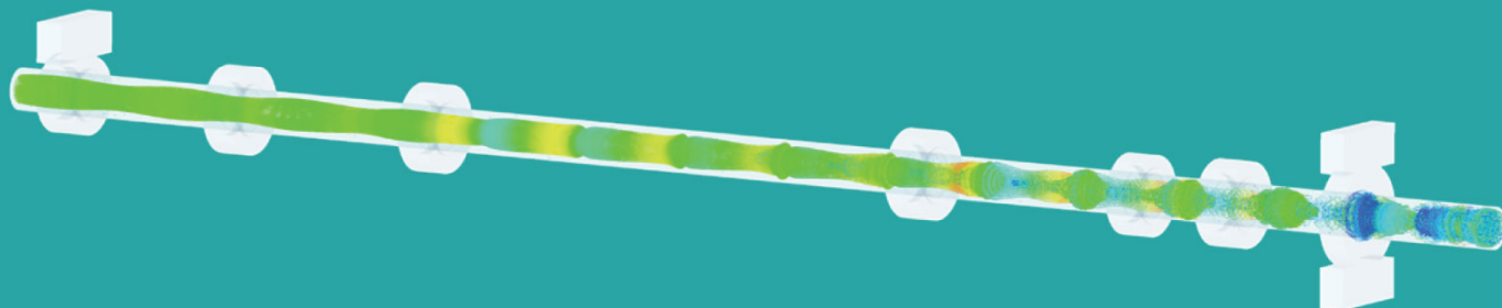
Траектории электронов, рассчитанные с помощью PIC вычислителя в клистроне длиной 1.24 метра. Хорошо видны сгустки электронов, формирующие высокочастотный сигнал.
