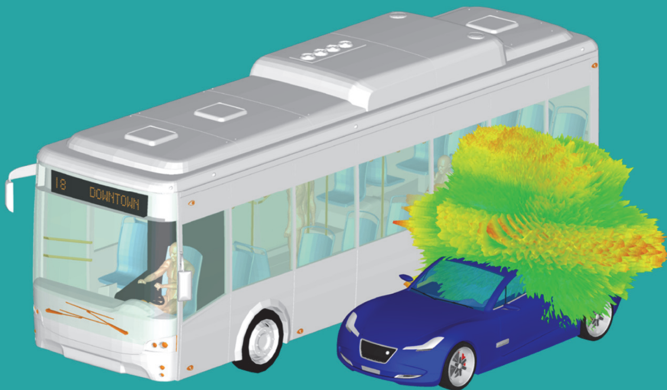
Пример расчета диаграммы направленности V2V антенны, установленной на легковом автомобиле, затененном стоящим рядом автобусом.
