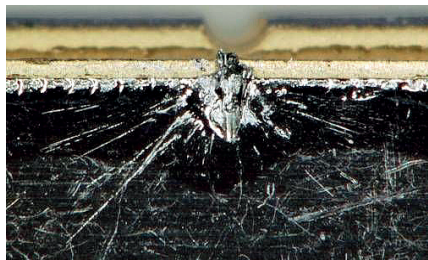
Дефект, вызванный резким фронтом импульса (крышка корпуса, вид сверху)
