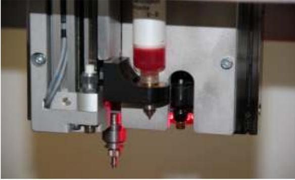
**Установка Amadyne EMU** предназначена для монтажа полупроводниковых компонентов различного типа и размера с использованием технологий монтажа на клей и эвтектику. Установка обладает визуальной системой позиционирования и контроля, автоматической сменой рабочего инструмента, эргономичным дизайном и интуитивно-понятным пользовательским интерфейсом.
