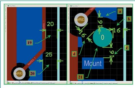
Рис. 4. Зазоры для KeepOut HoleSize
