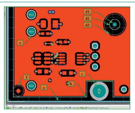
Рис. 2. Зоны, отмеченные в слое KeepOut
