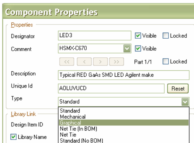
Рис. 7. Установка типа компонента для специальных требований
