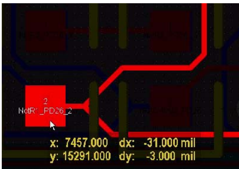
Рис. 7. Нажатие CTRL+Alt и наведение курсора на цепь позволяет подсветить ее на плате.
