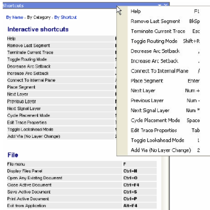
Рис. 35. Панель горячих клавиш и выпадающее меню горячих клавиш для интерактивной трассировки.
