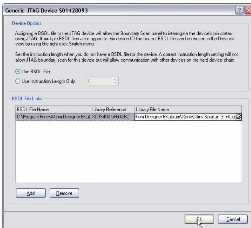
Рис. 14. Выбор файла BSDL и библиотеки для использования любого компонента JTAG.
