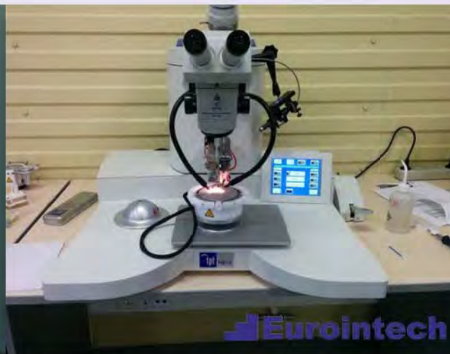
Ультразвуковая установка TPT HB16 для микросварки проволочных выводов
