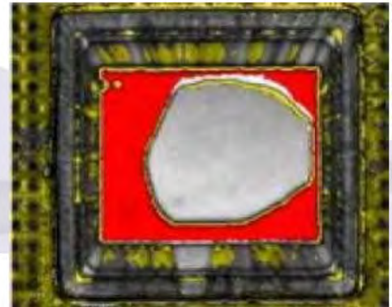
Результат акустического сканирования: красный цвет означает отслаивание
