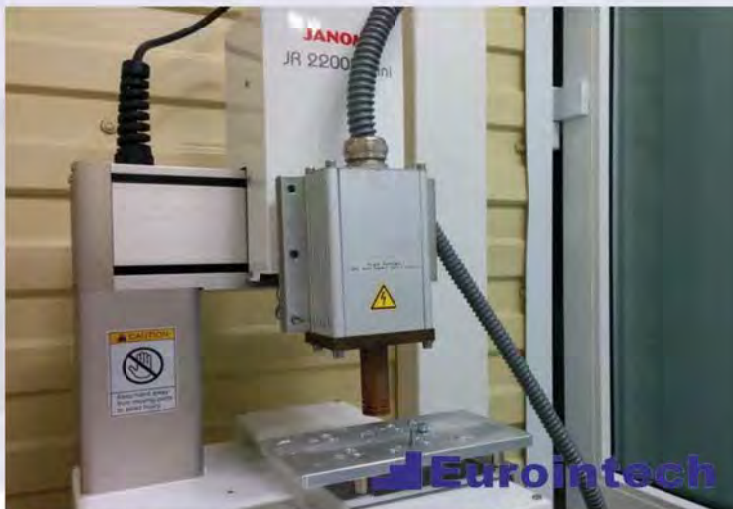
Генератор плазмы MonoJet, установленный на настольном роботе Janome
