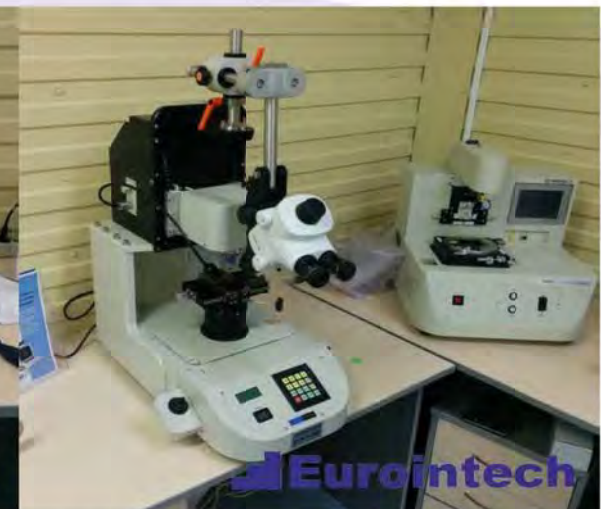
Тестер прочности механических соединений RHESCA PTR-1102
