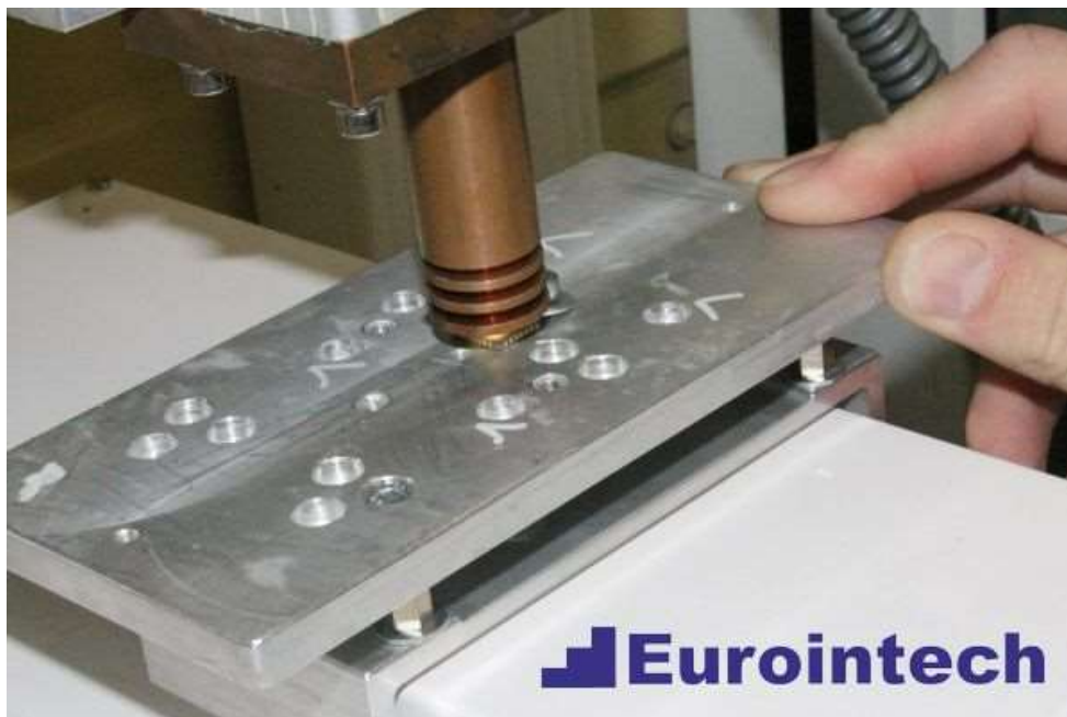
Рис. 6. Экспериментальный образец зафиксирован на рабочем столике настольного робота.
