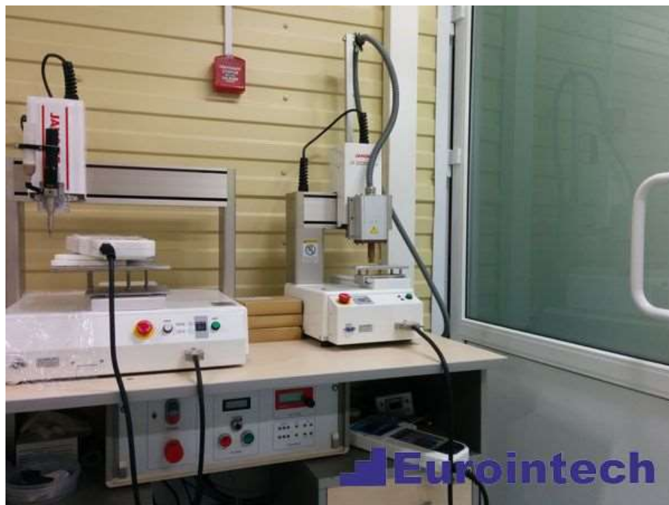
Рис. 5. Общий вид установки: настольный робот Janome, генератор плазмы (головка), источник питания установки MonoJet (под роботом).
