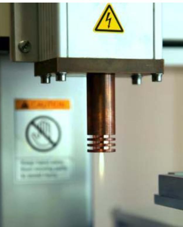
**Установка Monojet** предназначена для активации и увеличения адгезии поверхности перед такими операциями, как микросварка, нанесение клеев, красок, различных покрытий, а также для удаления фоторезиста и очистки поверхностей от загрязнений.
