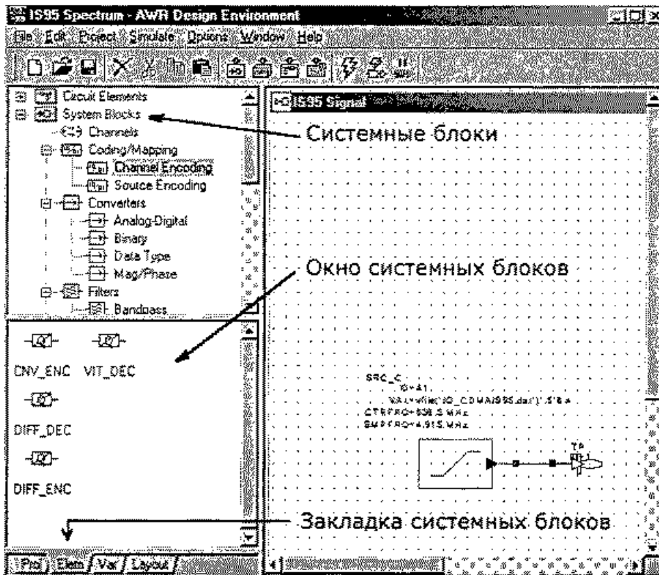
Рис. 10.7. Окно VSS и добавление подсистемы из окна системных блоков
