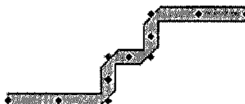
Рис. 9.124. Окончательная трасса с новым изгибом
