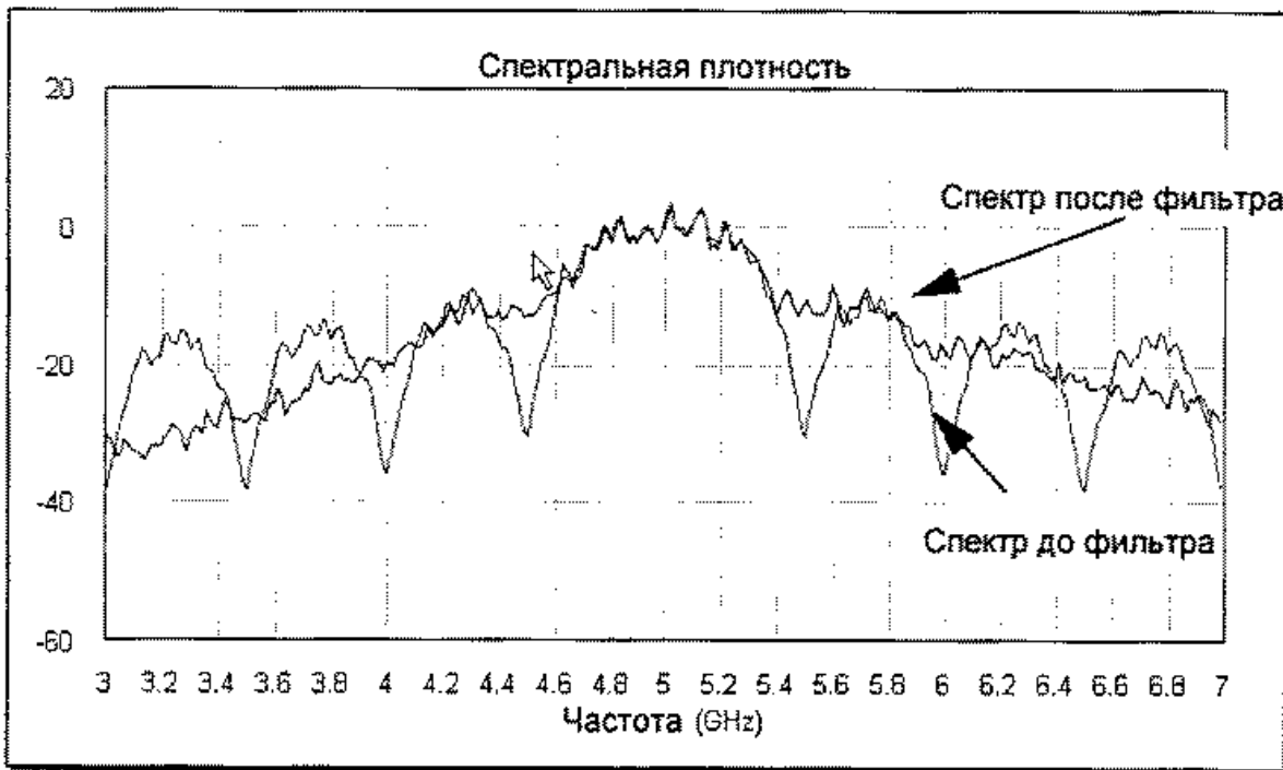
Рис. 10.32. Графики спектральной плотности до и после фильтра. Изменяя задержку фильтра спектр значительно изменяется
