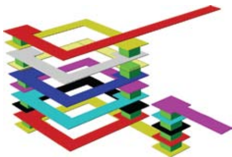
Рис. 3. Показанная здесь вертикальная LTCC катушка индуктивности позволяет снизить габариты и стоимость конечных устройств
