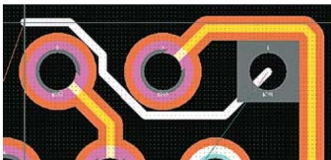
Рис. 10. Режим прорисовки проводников Pull Tight
