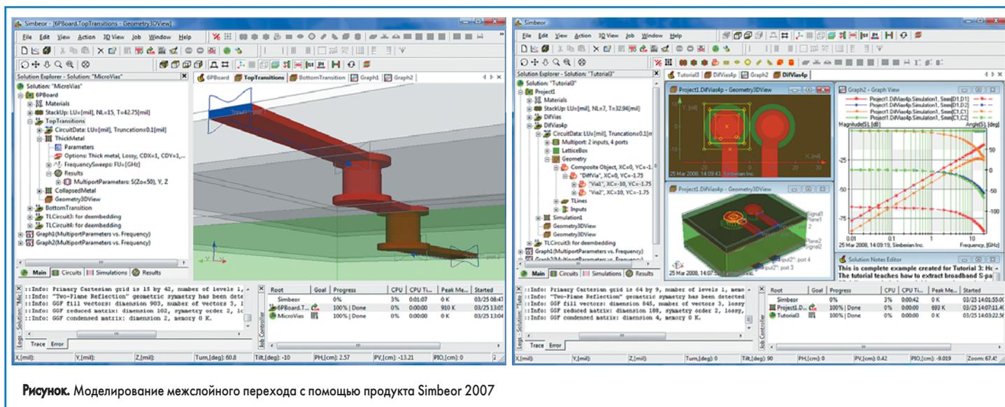
Рисунок. Моделирование межслойного перехода с помощью продукта Simbeor 2007
