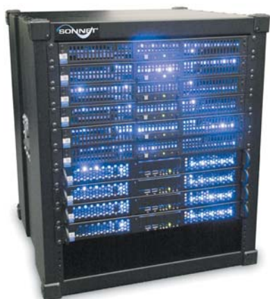
Рис. 5. Первая кластерная вычислительная система, собранная в компании Sonnet
