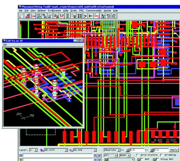
**Рисунок 3** Трассировка может выполняться как в обычном плоском, так и в трехмерном режиме
